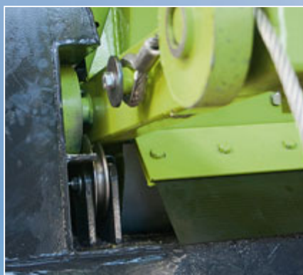
Der Schlitten vor der Montage: Über zwei Kunststoffrollen wird die Frontwand in dem U-Profil geführt. Das Band wird über Schrauben mit der Wand verklemmt. Beim Zurückziehen entfernt die Kunststoffleiste Erntereste.
