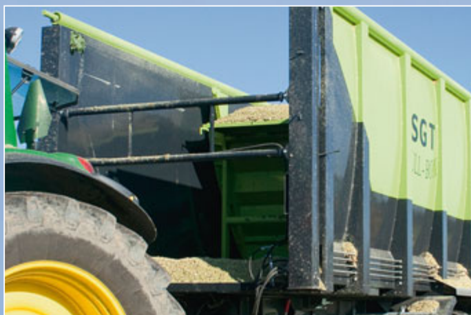
Zwei senkrechte Zylinder in den Vierkantröhren links und rechts ziehen über sechsfach umgelenkte Drahtseile das mit der Frontwand verbundene Rollband in nur 15 Sekunden zurück. Für eine bessere Sicht fehlt hier noch ein Fenster.
