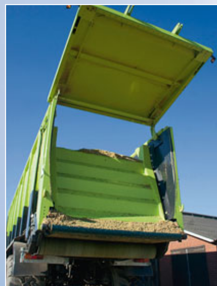
Die Heckklappe öffnet weit. Hier ist der Anschlag zum Abstellen des Bandes nicht richtig eingestellt, so dass kleine Mengen Silomais auf dem Wagen liegen bleiben.
