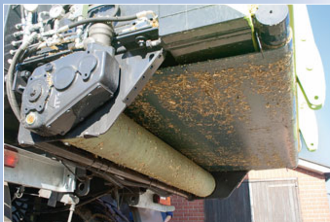
Das Band wird über eine Umlenkrolle auf die eigentliche Zugrolle geführt. Hydraulikmotoren links und rechts sorgen für den notwendigen Zug. Für die Serie soll ein Abstreifer vor der Zugrolle montiert werden. Ein Vierfachgewebe in dem Band sorgt für Reißfestigkeit.
